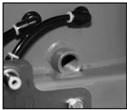
Fan Drain Connection
